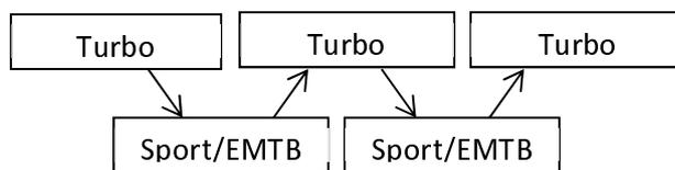
2. Geschwindigkeitslimit wird für 5 Sekunden angezeigt. Bei Bedarf wie in der Abbildung dargestellt durch Umschalten der Unterstützungsstufe anpassen. Mögliche Werte: 25..99km/h. Standardwert: 32km/h.
