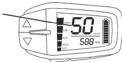
Dynamik-Modus aus: 50 km/h wird für 2 Sekunden angezeigt. Der eingestellte Wert wird gespeichert.
