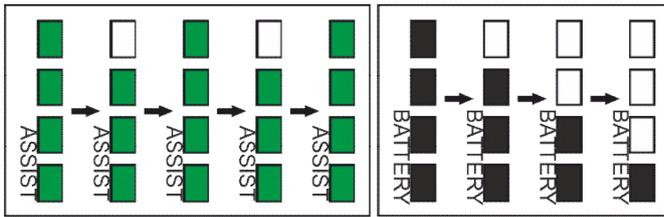
Mit „Pfeil oben“ und „Pfeil unten“ die Unterstützungsstufen wie abgebildet wechseln. Die Batterieanzeige quittiert die Eingabe indem die LED's schnell nacheinander ausgehen. Der Speed Modus ist aus.
