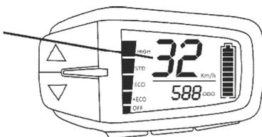
Geschwindigkeits-Limit wird für 5 Sekunden angezeigt. Standardwert 32km/h. Mögliche Werte: 25..45km/h
