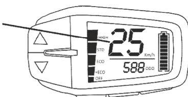
Das Display zeigt für 2 Sekunden 25km/h. Der Speed Modus ist aus.
