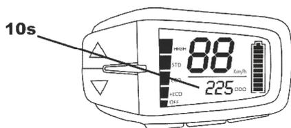
Der eingestellte Radumfang wird in Zentimetern als Gesamt- und Tageskilometerstand angezeigt (1 Zentimeter = 1 Kilometer). Die Geschwindigkeitsanzeige zeigt währenddessen 88km/h.
