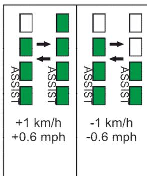
Das Limit kann durch ein hin- und herschalten zwischen den abgebildeten Stufen geändert werden. Der eingestellte Wert wird gespeichert, sobald Sie 5s keine Taste mehr drücken.
