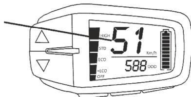
Dynamik-Modus ein: 51 km/h wird für 2 Sekunden angezeigt. Der eingestellte Wert wird gespeichert.
