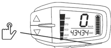
Bike einschalten. Als Gesamtkilometerstand wird „43434“ angezeigt. Bike wieder ausschalten. Dadurch wird der Code gelöscht. Anschließend Verkabelung wieder in ursprünglichen Zustand bringen.
