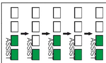
Bei aktiviertem Speedmodus mit den Pfeiltasten die Unterstützungsstufen wie abgebildet wechseln.
