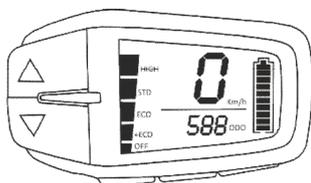
Wird für 10 Sekunden keine Taste gedrückt, wird wieder der Kilometerstand angezeigt und der eingestellte Radumfang wird gespeichert.
