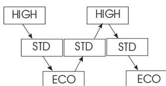
Mit „Pfeil oben“ und „Pfeil unten“ die Unterstützungsstufen wie abgebildet zügig wechseln.
